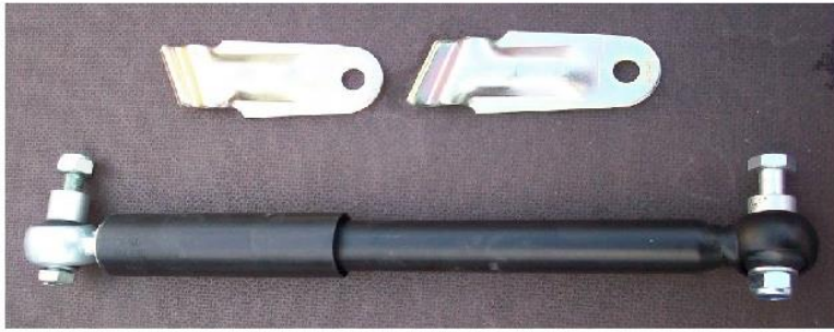
Achsstoßdämpfer und Stoßdämpferhalter (achsseitig) axle shock absorber and shock absorber holder (axle side)
